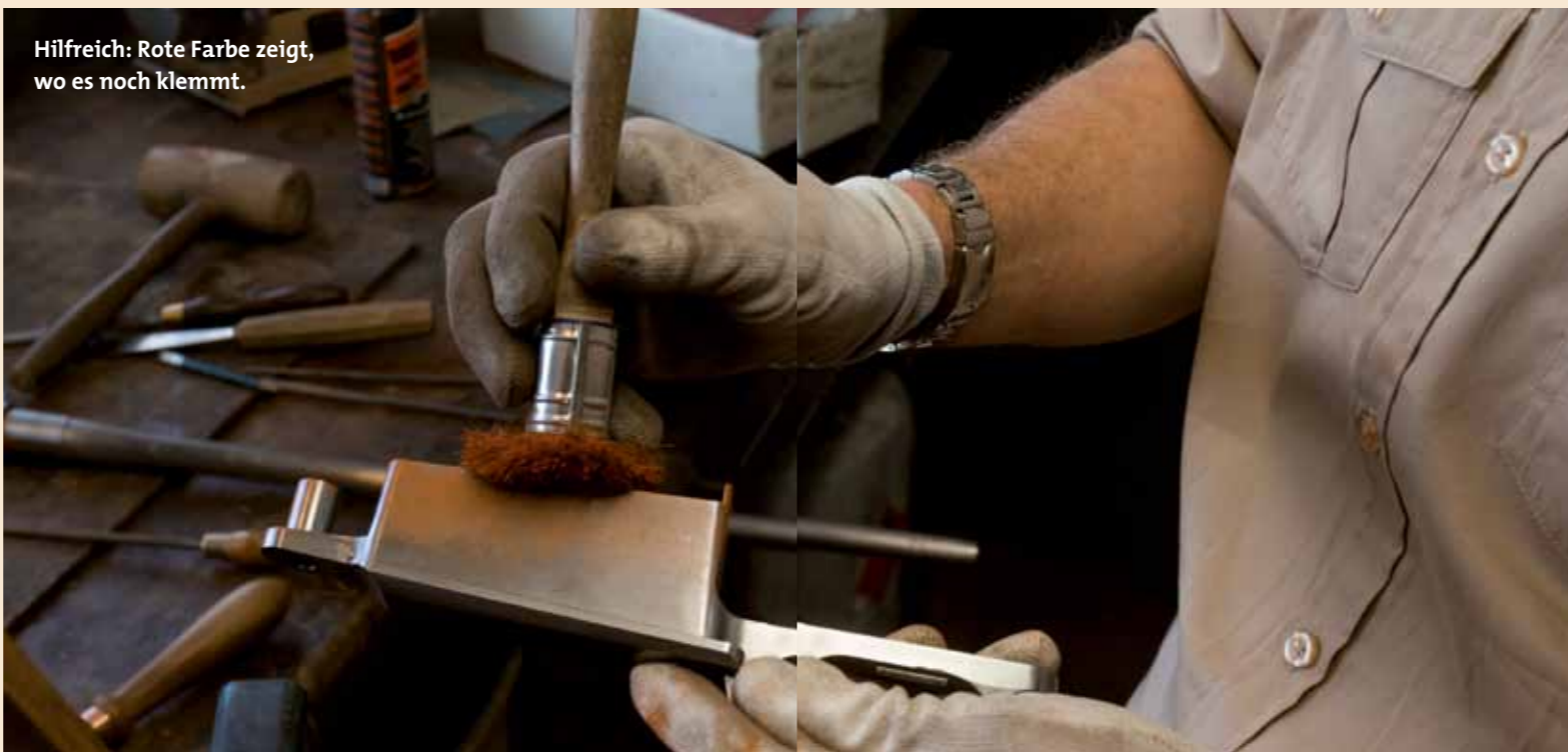
Passt: sauber in das Holz eingelassenes Mauser-System
